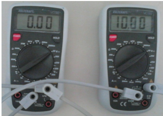
Слика 5.16. Вриједност напона нулиндикатора (лијево) и вриједност напона напајања (десно) за случај када је мост у равнотежи
